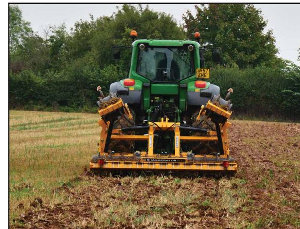
»» Einsatz bei 3 Meter Arbeitsbreite in eingeklappten Zustand
