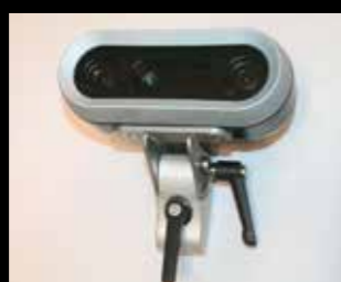
Camera met dubbele optiek, voor het volgen van 1 of meerdere rijen
