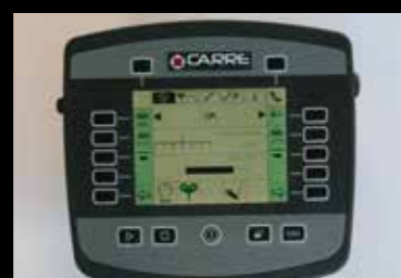
De bedieningscomputer geeft de kwaliteit van het signaal continu weer. Men kan de gewenste precisie instellen van uit de cabine van de trekker.
