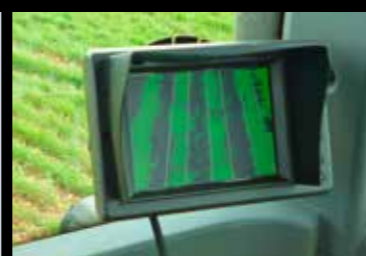
De bedieningscomputer geeft de kwaliteit van het signaal continu weer. Men kan de gewenste precisie instellen van uit de cabine van de trekker.
